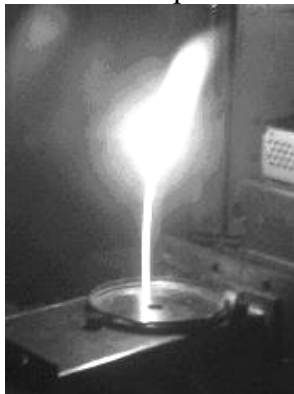
Рис.2. Факельный разряд в однопроводной линии Губо
